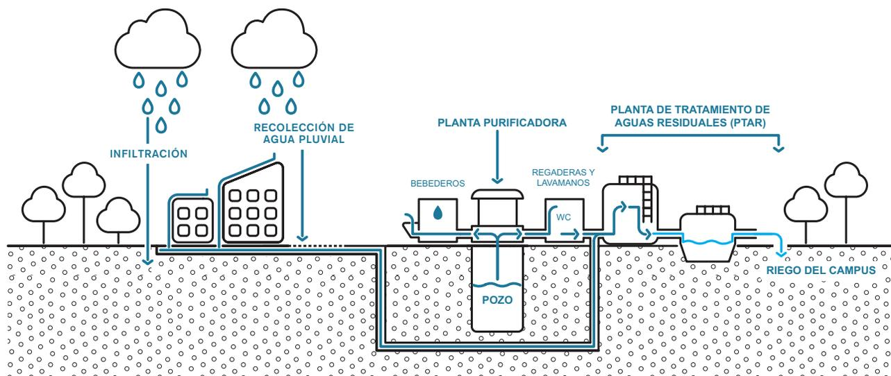
Figura 9. Sistema hidráulico del ITESO.
